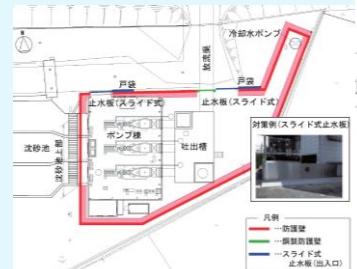
防水壁設置例（平面図）
