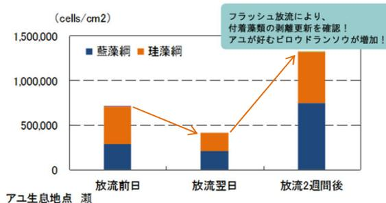
図4 付着藻類細胞数の経時変化
