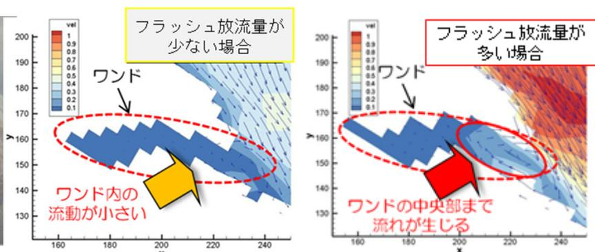
図6 平面2次元不定流計算によるワンド周辺の流速ベクトル・コンター
