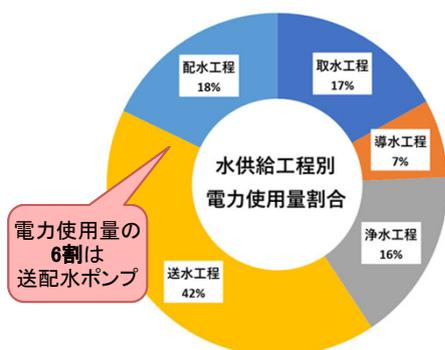
図2 水供給工程別電力使用量割合
