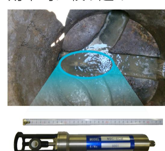
\*水質測定(電気伝導度、温度など)による不明水調査は、日水コンの特許(特許第4980478号不明水流入箇所特定装置)です。
