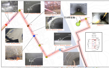
図9 下水道管路災害査定資料
