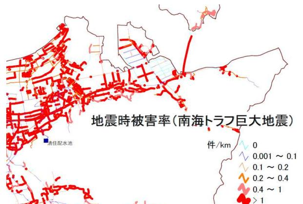
図-3 管路被害予測結果の図面化
